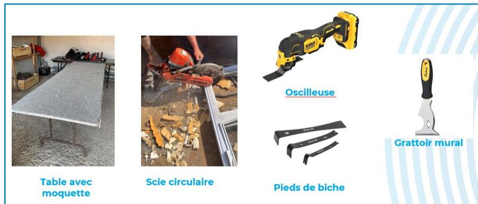
Figure 22 Exemples d'outils efficaces pour le démantèlement des portes et fenêtres
